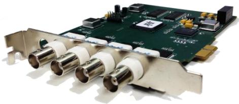
OK\_MC40B(-E)是基于 PCI/PCI-E 总线的黑白/彩色图像采集卡,输入视频为 PAL 制、NTSC 制标准视频。一槽四卡,可实现四路同时独立采集。该卡自带帧存,能同时触发四路通道,保证抓拍图像的清晰度及完整性,同时还具有四入四出控制信号,完美同步闪光灯。
