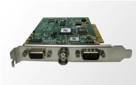
OK\_M30B(-E)是基于 PCI/PCI-E 总线的可采集标准和非标准视频信号的 10bit 高档图像采集卡，实现了 PCI 总线传输、存贮、处理和显示均为真正的 10bits。采集图像总线占用时间与 CPU 可使用总线时间之比为 1/4 的分享总线技术，传输速度最高可达 132MB/s，适用于图像实时处理。
