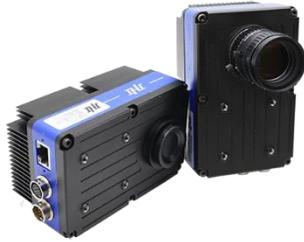
OK\_IM2366 是一款基于 x86 平台的智能相机, 搭载 Sony 高性能全局快门传感器以及 Intel 新一代超低功耗 Atom 处理器, 集成 FPGA 进行图像预处理功能。
