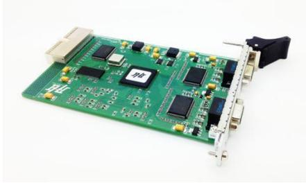
OK\_CPC50B 是基于 Compact PCI 总线可采集标准/非标准黑白视频的图像降噪输出采集卡。该卡具有反馈式递归数字滤波器，滤波系数 15 级可选。具有模拟输出回放功能，可输出视频信号到专用模拟视频设备及多幅机上，且输出信号模式可任意调节（隔行/逐行）。
