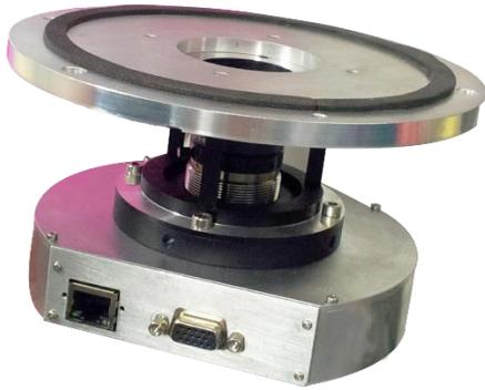
OK\_AM1566 摄像头为我公司特别推出的 X-Ray 专用千兆网摄像头，可配合我公司的千兆网 CCU 组成完整的 X-Ray 影像链系统。高动态范围，可有效降低 X 射线的剂量，广泛适应于目前流行的各种影像增强器，系统集成简便。该摄像头具有对比度范围广、灵敏度高、电动调焦调光圈等功能；丰富的 I/O 接口，便于控制 X 光机同步；优秀的图像质量，实时处理医疗诊断图像，实时降噪，边缘增强，shading 校正，坏点校正；采用千兆网做数据传输接口，简化连接程序，降低设备成本，便于生产维护。
